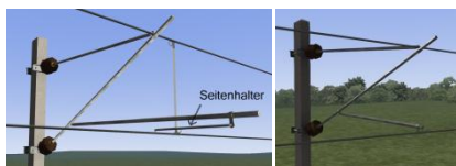
a) Ausleger mit Seitenhalter, b) Ausleger ohne Seitenhalter markiert mit "Lf" im Auswahl.
